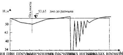
Рис. 32.10. Всплески отметок дна в зоне растекания при преувеличенном расчетном интервале времени
