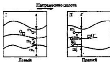
Рис. 7.12. Изображение поверхностных поплавков на смежных аэрофотоснимках I и II: O, O' - главные точки снимков; m - точки, фиксированные индикатором; a-a' - постоянный створ
