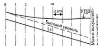
Рис. 31.12. Схема деления рассматриваемого участка лога на расчетные интервалы блины Dl
