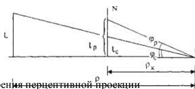
Рис. 34.4. Схема к выводу расчетных формул для построения перцептивной проекции
