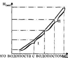
Рис. 32.6. Аналитическое представление кривой связи опорного водопоста с водопостом по оси мостового перехода
