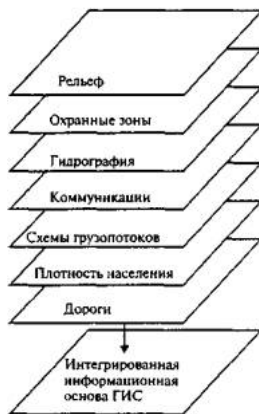
Рис. 3.1. Пример совокупности тематических слоев, как интегрированной основы графической части ГИС
