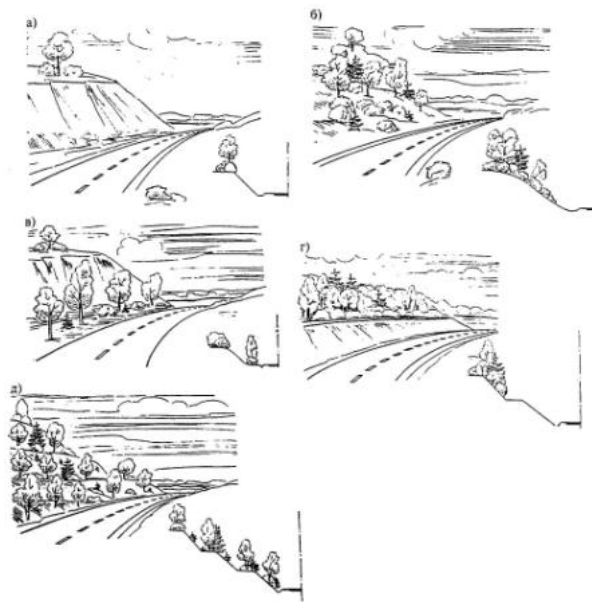
Рис. 9.7. Способы маскировки высоких обнаженных откосов насыпей и выемок растительными посадками:
