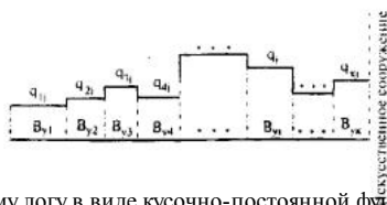
Рис. 31.2. Представление боковой приточности по главному логу в виде кусочно-постоянной функции
