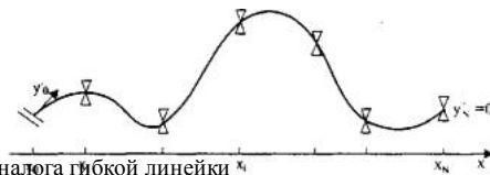
Рис. 28.7. Очертание сплайна как математического аналога гибкой линейки
